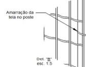
**ESTRUTURA** Estrutura para poste intermediário e esticadores perfil tubular 2" (50.8 mm), Estrutura para as Escoras perfil 1.1/2" (38.1mm). Para utilização de outros tipos de perfil, sob consulta
